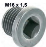
vis de vidange M16x1,5-12 Peugeot, Renault (creux 4 pans 8x8mm) non aimantée, tous moteurs, Citroën AX, BX, XM
