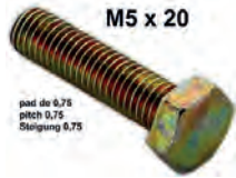
vis M5x20, Citroën, boulon bichromaté jaune à tête hexagonale, filetage au pas de norme S.I.m. 0,75 comme montage d'origine Citroën jusque 04.1970. Attention: les vis modernes à la norme ISO ont un pas de 0,80.
