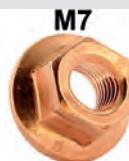
écrou cuivré M7 pour tubulure d'échappement par exemple. Il est important d'utiliser des écrous cuivrés sur la tubulure d'échappement et sur l'échappement en général pour qu'ils ne collent pas à chaud et afin d'éviter la rouille
