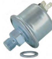
sonde de pression d'huile, plage de mesure 0 à 6 Bar, déclenchement à 0,6 bar pas de vis M14 x 150, Renault R5 toute (également Alpine)
