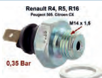
manocontact d'huile, Renault 4L après 1967, R5, R16, Citroën CX1 2000-2200, CX2 20RE, Peugeot 505 2.0+2.2, M14x1,5, pression 0,2-0,45 Bar
