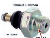
manocontact d'huile, Renault 4L 747cm 3 de 1962 à 1967, Dauphine, Floride, R3, Citroën HY, M14x1,5, pression 0,5 Bar
