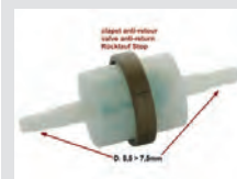
filtre à carburant avec clapet anti-retour, pour essence ou gasoil. Le clapet retient le carburant dans la durite et la pompe. L'essence arrive ainsi plus vite au carburateur et la membrane de pompe ne dessèche pas même lorsque la voiture reste arrêtée longtemps. Le levier de pompage manuel sur certaines ancienne devient superflus. Pour durites de diamètre intérieur de 5,5 à 7,5mm
