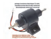
pompe à essence électrique 12 volts, utilisation universelle pour moteurs essence à carburateurs. Montage simple, adapté pour de nombreux véhicules anciens et de collection. Pression/kg: 0,5-0,7. Débit max.: 130L/h. Utilisation tous carburants possible: essence, gazoil, ethanol ou metahnl. Raccord standard 6mm
