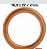
joint de vis de vidange, 2CV, BX, XM, Peugeot 204, 203, 304, 404, 504. 16,3x22x2mm, joint cuivre type C, profile bombé avec couverture PTFE
