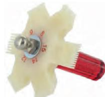
peigne à radiateur, outil permettant de mettre en forme les lamelles de nids d'abeilles des radiateurs d'eau, radiateurs d'huile et radiateurs de chauffage. 6 dimensions différentes.
