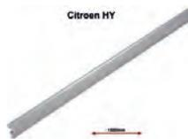
profilé en aluminium (1500mm) pour les panneaux latéraux de caisse, Citroën HY anciens modèles, pour panneaux d'origine vissés à la structure. Longueurs nécessaires pour un HY court = 2x 2400mm, 2x 1630mm, 4x 630mm; longueur de réf 48262=1500mm, longueur de réf 48263=1000mm
