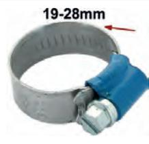
collier de serrage pour durite 19-28mm. Collier rétro avec les bords remontés pour éviter de blesser le caoutchouc. Petite vis de serrage 7mm. Largeur : 12mm. Protection meilleure que les colliers modernes et style rétro bien en accord avec les véhicules de collection anciens.
