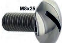
vis Inox de grille de calandre, Traction - 11cv et 15cv, 8mmx25, diamètre de tête 20mm, n° d'origine 331101, également pour pare-chocs Peugeot et autres
