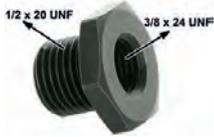
adaptateur, réducteur de 1/2" UNF (mâle) à 3/8" UNF (femelle), pour pas de vis du raccord de flexible sur Hydrovac ref. 74505 par exemple
