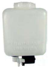
réservoir de lave-glace, Renault 4L, avec pompe électr., 12 volts, comme d'origine, compatible sur de nombreuses anciennes, le réservoir a presque la même forme que sur les dernières 2CV. Dimensions hors-tout (fixations comprises): largeur 17,5cm, hauteur 19,5cm, profondeur 11cm.
