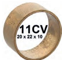
bague de machoières de frein en bronze, Traction - 11cv, 20-20,15 x 22 x 10mm, n° d'origine 438314, adaptable sur Citroën HY en les réduisant à une longueur de 8,5mm comme n° d'origine ZY9438656U
