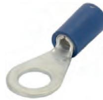
cosse à sertir ronde, diamètre 6mm langue à visser, bleu: pour fil de 2,3 à 5,0mm
