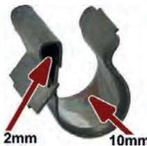
agrafe de fixation de tube de diamètre jusque 10mm (durites d'eau, essence, faisceau électrique...), agrafe métallique pincée sur toute tôle d'épaisseur jusque 2mm
