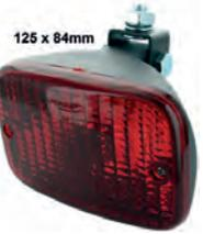
feu de brouillard arrière boîtier plastique, 2CV, DS, Peugeot, dimensions: largeur 125mm, hauteur 84mm, refabrication
