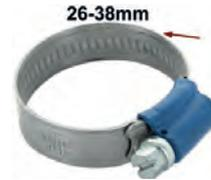
collier de serrage pour durite 26-38mm. Collier rétro avec les bords remontés pour éviter de blesser le caoutchouc. Petite vis de serrage 7mm. Largeur : 12mm. Protection meilleure que les colliers modernes et style rétro bien en accord avec les véhicules de collection anciens.
