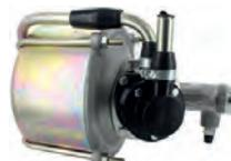
assistance de freinage type Hydrovac, produit universel pour tous véhicules anciens. Grand modèle 7 pouces (17,8 cm), pour simple circuit, permet d'équiper un véhicule de l'assistance au freinage ou en remplacement d'un hydrovac défectueux (Peugeot 404). La dépression peut être fournie par une pompe électrique ou par la tubulure d'admission. Raccords hydrauliques 1/2 x 20 UNF. Montage de tubes flexibles en diamètre 3/8 UNF avec nos réducteurs 74561 + 74565. Made in Spain.
