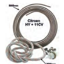
réservoir d'essence, Citroën DS et HY, kit tube, durites et colliers pour raccordement de l'alimentation. Comprend: tube rigide en alliage cupro-nickel 5m., durite aviation 2m., filtre à clapet anti-retour + 6 colliers
