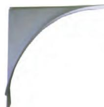
triangle avant droite, Citroën HY, tôle sous la porte, entre aile et montant vertical de caisse
