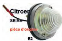
feu de recul ou clignotant blanc, Citroën 2CV avant (sans son support), AK400, Méhari et DS break arrière, HY, adaptable sur Renault 4L série 1, produit d'origine Seima 3054, 3055, homologué ECE, socle et porte ampoule en métal, diam. du cabochon 68,5mm
