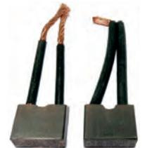
balais de démarrage, DS après 1971, démarrage Paris-Rhône série D10, largeur 18mm, épaisseur 7mm, hauteur 14mm
