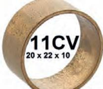
bague de machoires de frein en bronze, Traction - 11cv, 20-20,15 x 22 x 10mm, n° d'origine 438314, adaptable sur Citroën HY en les réduisant à une longueur de 8,5mm comme n° d'origine ZY9438656U
