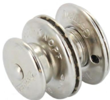
bouton Tenax, partie inférieure (mâle) pour tôle ou polyester, vis à tôle de diam. 4,2mm et long. 16mm.
