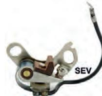
rupteur SEV petit modèle, DS et ID, 11CV, Peugeot 404 après 1968, Renault 4L ancienne et divers
