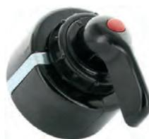
commodo de clignotant mécanique, Citroën Traction et autres véhicules de collection, n° d'origine 706312, témoin au levier, fonctionne en 6 volts et en 12 volts, livré sans son ampoule (commander ref 14425, 14282 / douille Ba7s) Pour mettre l'ampoule : appuyez au centre du le levier, tournez le vers la lettre R en le tenant appuyé, puis tirer de l'axe vers vous.
