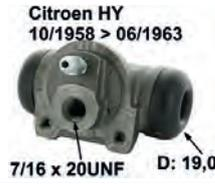
cylindre de roue, Citroën HY de 10.1958 à 06.1963, arrière, n° d'origine HY45305C, piston 19 mm, raccord 7/16x20UNF, raccord flasque 36 mm, longueur hors tout 68 mm. Made in France
