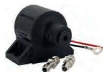
pompe à essence électrique 12 volts, utilisation universelle pour moteurs essences à carburateurs. Montage simple, adapté pour de nombreux véhicules anciens et de collection. Pression/kg: 0,5-0,7. Débit max.: 130L/h. Utilisation tous carburants possible: essence, gasoil, ethanol ou methanol. Raccord standard 6mm
