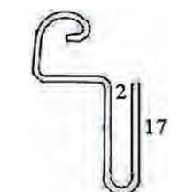
rail de charnière (partie male), Citroën HY, charnière type Yoder pour capot moteur et porte arrière en bas, partie soudée à l'ouvrant, longueur 145cm. Refabrication renforcée, tôle doublée, mieux que d'origine, produit de qualité, fabrication européenne
