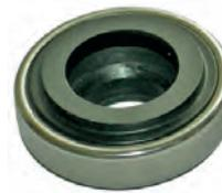
bague cyclam d'étanchéité de pompe à eau, Traction - 11cv et 15cv, HY, diam. ext 35mm, diam. int. 15mm, hauteur max 17mm, haut. min. 13mm, n° d'origine 456399
