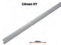
profilé en aluminium (1000mm) pour les panneaux latéraux de caisse, Citroën HY anciens modèles, pour panneaux d'origine vissés à la structure. Longueurs nécessaires pour un HY court = 2x 2400mm, 2x 1630mm, 4x 630mm; longueur de réf 48262=1500mm, longueur de réf 48263=1000mm
