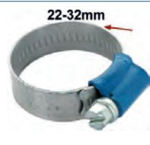
collier de serrage pour durite 22-32mm. Collier rétro avec les bords remontés pour éviter de blesser le caoutchouc. Petite vis de serrage 7mm. Largeur : 12mm. Protection meilleure que les colliers modernes et style rétro bien en accord avec les véhicules de collection anciens.
