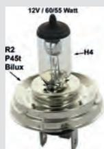
ampoule 12volts, type Code Européen culot P45T (modèle R2), 60/55 Watt, ampoule à iode comme type H4
