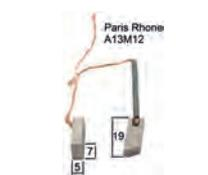
charbons pour alternateur 12 volts, Paris-Rhône A13M12, Citroën, Peugeot, Renault, 2CV, DS après 06.1972, dimensions: L 19mm, E 5mm, H 7mm.
