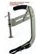
lève-soupape pour démonter les soupapes et ressorts sur culasses de voitures anciennes, outil semi-professionnel. Dans certains cas, intercalez une pièce cylindrique (douille...) pour augmenter la longueur du vérin
