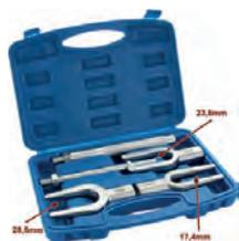
kit de fourches arrache rotules, 5 pcs en acier trempé. 3 fourches: 17,4 mm - 23,8 mm - 28,5 mm, 1 manche de 200 mm, 1 manche adaptateur pour percussion par marteau pneumatique diam. 10 mm, longueur 175 mm. L'outil idéal pour les biellettes de suspension et autres rotules.
