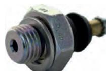
manocontact, sonde de pression d'huile, Citroën DS et ID jusque 1965, moteurs 3 paliers, HY, 2CV et Ami 6 moteurs bicylindres sans filtre à huile, M14x150
