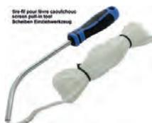
tire-fil pour pose de vitres voitures et pare-brise non collées. Outil très pratique avec un cordon permettant de tirer la lèvre caoutchouc d'un joint sur la feuillure de tôle. Indispensable dans les garages et ateliers spécialisés véhicules anciens et de collection.
