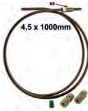
tube hydraulique de secours pour frein ou suspension. Tube de 4,5mm en alliage cupronickel, longueur 1m, avec un raccord Citroën, un joint tube et 2 raccords bicône. Indispensable en cas de panne.
