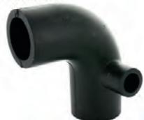
durite de radiateur, Citroën HY après 09.1963, durite supérieur de liquide de refroidissement, coude 90°, 3 raccords, diamètre extérieur: 50+50+25 mm. N° d'origine HY23510A
