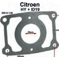
joint de tubulure d'admission, ID19, HY après 1963, n° d'origine DM141-11B, diamètre 39mm, entraxe horizontale 100mm, entraxe verticale 62mm, trous de 8,1mm pour les goujons.
