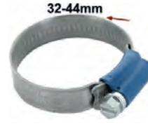
collier de serrage pour durite 32-44mm. Collier rétro avec les bords remontés pour éviter de blesser le caoutchouc. Petite vis de serrage 7mm. Largeur : 12mm. Protection meilleure que les colliers modernes et style rétro bien en accord avec les véhicules de collection anciens.
