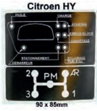
autocollant grille de passage des vitesses, Citroën HY, avec pression de gonflage, nouveau modèle
