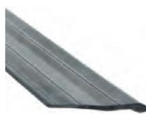
profilé caoutchouc pour joints de porte ou coffre, Citroën 2CV, HY, DS... le mètre, produit de qualité Made in Germany! matériau EPDM 317 légèrement couvert de talc, largeur 25,5mm
