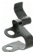
agrafe de tige de commande d'accélérateur, Citroën 2CV, HY, n° d'origine AZ124-121, sauf 2CV6 avec un câble de commande. Attention : notre ref 10690 est une agrafe de forme symétrique
