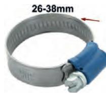
collier de serrage pour durite 26-38mm. Collier rétro avec les bords remontés pour éviter de blesser le caoutchouc. Petite vis de serrage 7mm. Largeur : 12mm. Protection meilleure que les colliers modernes et style rétro bien en accord avec les véhicules de collection anciens.
