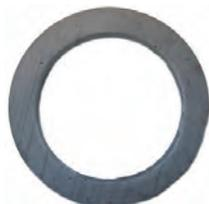
joint de tube d'échappement, HY diesel Indenor et Peugeot J7, moteurs XDP88, XDP90, XDPX90 (1948cm3 + 2112cm3 + 2304cm3), diamètre int. 47mm, ext. 66mm, n° d'origine 171007 + 171078
