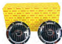
klaxon 12 volts, chromé, marque Bosch. Fréquences: 325 et 400 Hz, niveau sonor 118 db(A), 2 x 48 W, diam. 156 mm, profondeur 91 mm, universel
