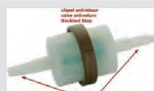
filtre à carburant avec clapet anti-retour, pour essence ou gasoil. Le clapet retient le carburant dans la durite et la pompe. L'essence arrive ainsi plus vite au carburateur et la membrane de pompe ne dessèche pas même lorsque la voiture reste arrêtée longtemps. Le levier de pompage manuel sur certaines ancienne devient superflus. Pour durites de diamètre intérieur de 5,5 à 7,5mm
