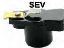
rotor SEV pour tête de Delco 48134 à charbon fixe, Citroën Traction 11CV, HY, DS, Peugeot, diam. int. 14mm (sur axe de l'allumeur), profondeur int. 8,5mm, hauteur HT 50mm.
