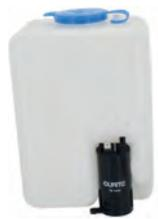
réservoir de lave-glace électrique 12 volts avec pompe intégrée, Contenance: 1,2 l. Largeur: 122mm, hauteur HT: 185mm, épaisseur HT: 100mm. Le support livré avec le kit est discrettement caché au dos du réservoir
