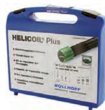
kit de réparation Helicoil - pour réparer un pas de vis abîmé, pour les pas de vis M7. Outils : mèche + taraud + outil de pose. filets: 10x Helicoil M7 de chaque longueur: 7,0mm, 10,5mm, 14,0mm - Produit de marque Helicoil
