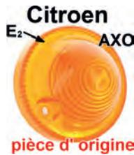
cabochon de clignotant, Citroën 2CV, DS break arrière, HY avant+arrière, adaptable Renault 4L avant, diam. ext 71mm, entraxe env. 55mm, hauteur de la collerette à l'int.: 14,5mm, l'unité, pièce d'origine AXO homologuée ECE
