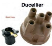
tête d'allumeur avec son rotor Ducellier, Alpine 1300 de 01.1974 à 12.1975, Citroën DS, HY, Peugeot 204, 304, 404, 504, Renault R4, R5, R6, R10, R12, R15, R16, R17, R20. Hauteur HT 65mm, diam. int 65mm.
