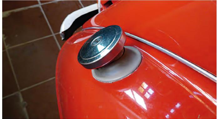
collerette de remplissage de réservoir sur aile arrière, caoutchouc noir, Citroën 2CV jusque env. 1967, HY jusque 09.1968, refabrication
