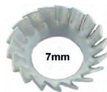
rondelle éventail, Citroën Traction - 11cv et autres anciennes, diamètre int. 7mm, ext. 14mm, fixation de tambour de frein, rondelle en cuvette à denture ext.
