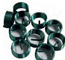
files rapportés pour réparer un pas de vis abîmée, Helicoil M14x1,25x12,7 pour bougies par ex., 10pces, se monte avec l'outil 20947
