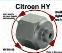
écrou de cardan droite, Citroën HY, filetage pas à gauche, n° d'origine H4168E, couple de serrage 20kgf.m - 200N.m / Made in Germany. Nous avons modifié la dimension pour un serrage avec une douille normale de 36, au lieu du 38 long d'origine.
