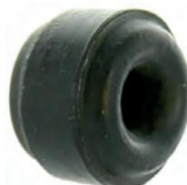
capuchon de vis de purge étrier de frein + cylindre de roue, Citroën, Peugeot, Renault
