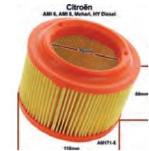
cartouche de filtre à air, Citroën Ami 6, Ami 8, Méhari + HY Diesel, n° d'origine AM1715, diamètre ext. 118mm, int. 75mm, hauteur: 88mm
