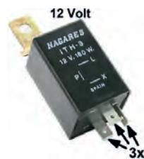
centrale de clignotants 12 volts, 2CV, DS, HY, 3 branchements, 180 Watt, sans bruiteur, adaptable sur de nombreux véhicules anciens Peugeot, Renault etc. Sur relais français : signe + = plus alimentation, signe C = clignotants avant+arrière, signe R = témoin tableau de bord. Sur relais japonais : signe X ou B = plus alimentation, signe L = clignotants avant+arrière, signe P = témoin tableau de bord
