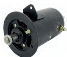
dynamo Ducellier 12 volts, 11 Ampere, modèles 7361A, profondeur 160mm, diam. 100mm, adaptable, tourne dans le sens des aiguilles d'une montre La série 73 des dynamo Ducellier a souvent été monté dans les années 50 et 60 entre autre Simca, Citroën DS, TrACTION, HY, Peugeot 203, 403, 404, 204, Renault Dauphine, Floride, 4CV, R4. Produit neuf d'origine Renault adaptable en utilisant les fixations de votre voiture
