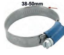
collier de serrage pour durite 38-50mm. Collier rétro avec les bords remontés pour éviter de blesser le caoutchouc. Petite vis de serrage 7mm. Largeur : 12mm. Protection meilleure que les colliers modernes et style rétro bien en accord avec les véhicules de collection anciens.
