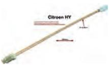
tube de frein avant, Citroën HY, tube entre flexible et cylindre de roue, longueur env. 265mm, diam. 6,35mm
