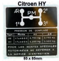
autocollant grille de passage des vitesses, Citroën HY, avec pression de gonflage pour les montes spéciales
