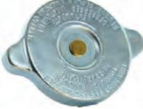
bouchon de radiateur, DS carbu toutes sauf DS23, également sur HY ess. à partir de 1963. Pression 0,28 bar. Pour toutes DS sauf modèles avec vase d'expansion (DS21 inj. et DS23), diam. int. 57mm, joint de diam. 38mm. Note: les modèles sans vase d'expansion ont un bouchon de radiateur sans le joint interne du couvercle, n° d'origine 5418102N
