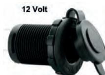
prise 12 volts, correspond à une prise d'allume-cigare. Diamètre de montage 29mm, profondeur 48mm.
