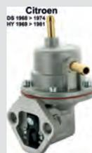
pompe à essence, Citroën DS de 1965 à 1975, Citroën HY 1968>, entièrement en métal, d'aspect proche de la pièce d'origine, Made in EU. Montage: ajuster la distance entre la tige de commande et le levier en ajoutant des joints papiers ou en désépaississant la cale thermique
