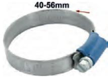
collier de serrage pour durite 40-56mm. Collier rétro avec les bords remontés pour éviter de blesser le caoutchouc. Petite vis de serrage 7mm. Largeur : 12mm. Protection meilleure que les colliers modernes et style rétro bien en accord avec les véhicules de collection anciens.
