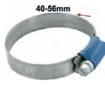
collier de serrage pour durite 40-56mm. Collier rétro avec les bords remontés pour éviter de blesser le caoutchouc. Petite vis de serrage 7mm. Largeur : 12mm. Protection meilleure que les colliers modernes et style rétro bien en accord avec les véhicules de collection anciens.
