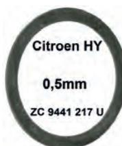
rondelle de calage (0,5mm), Citroën HY, pour le réglage d'épaisseur du bras au demi-train, diamètre 36,3 x 42mm, n° d'origine ZC 9441 217 U
