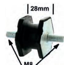
caoutchouc de fixation d'échappement (silentbloc), diamètre 40mm, hauteur env. 28mm, pas de vis M8
