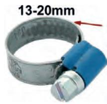
collier de serrage pour durite 13-20mm. Collier rétro avec les bords remontés pour éviter de blesser le caoutchouc. Petite vis de serrage 7mm. Largeur : 9mm. Protection meilleure que les colliers modernes et style rétro bien en accord avec les véhicules de collection anciens.
