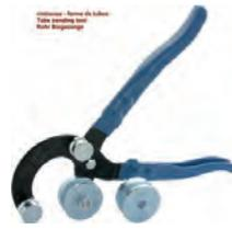
cintreuse, pince pour la mise en forme de tubes hydrauliques de frein. Outillage professionnel pour tubes acier, cuivre, alliage et alu. Pour former des angles jusque 90°, pour tube de Ø: 3/16"(4,75mm), 1/4"(6,35mm), 5/16"(7,93mm), 3/8 (9,52mm)
