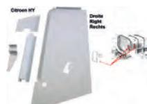
passage de roue, Citroën HY, côté droit, tôle de réparation de partie avant et milieu, n° d'origine H821-93A
