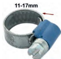
collier de serrage pour durite 11-17mm. Collier rétro avec les bords remontés pour éviter de blesser le caoutchouc. Petite vis de serrage 7mm. Largeur : 9mm. Protection meilleure que les colliers modernes et style rétro bien en accord avec les véhicules de collection anciens.
