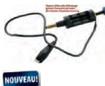
testeur de contrôle d'intervalle d'allumage. Outil simple et économique permettant de vérifier la tension d'allumage et la puissance de l'étincelle des bougies. Si le moteur de démarre pas, vérifiez d'abord les bougies. Si l'allumage ne fonctionne pas, la panne est donc électrique. Et si l'allumage fonctionne, la panne vient donc de l'alimentation en essence ou de la carburation.
