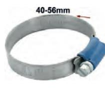
collier de serrage pour durite 40-56mm. Collier rétro avec les bords remontés pour éviter de blesser le caoutchouc. Petite vis de serrage 7mm. Largeur : 12mm. Protection meilleure que les colliers modernes et style rétro bien en accord avec les véhicules de collection anciens.
