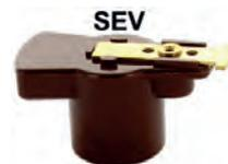
rotor SEV, Renault 4L et moteurs arrière, n° d'orig. 8556679, Peugeot 203, 403, 404, Citroën DS, HY, pour allumeur SEV avec arbre de 14mm. Longueur HT: 50mm, hauteur HT: 25mm, diam. int: 14mm.
