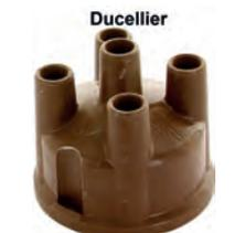
tête d'allumeur Ducellier D216, DS jusque 1972, HY, Traction, Peugeot 403, 204, 304, 404, 504, Renault R4, R16, rotor=34109, sorties verticales. Hauteur HT 65mm, diam. int 65mm. Made in France.
