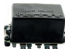
régulateur de charge courant continu pour dynamo 12V, universel, raccords E=masse, D=D+ de la dynamo, WL=cosse 15 de témoin de contrôle, F= excitation dynamo, B=batterie plus. N'est pas compatible avec un alternateur!
