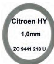
rondelle de calage (1,0mm), Citroën HY, pour le réglage d'épaisseur du bras au demi-train, diamètre 36,3 x 45 x 1,0mm, n° d'origine ZC 9441 218 U
