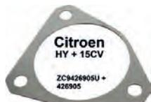
entretoise de 0,5mm, Citroën HY, 15CV, cale de réglage sous silentbloc de bras inférieur du train avant, n° d'origine ZC9426905U + 426905
