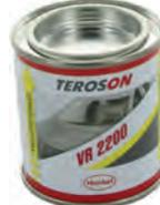
pâte à roder, pour rodage de soupapes à la culasse, boîte de 100ml - contient le gros grain et le grain fin pour la finition
