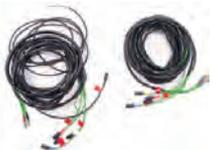
faisceau électrique, uniquement partie arrière, Citroën HY empattement normal (C). Made in Germany.
