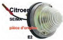
feu de recul ou clignotant blanc, Citroën 2CV avant (sans son support), AK400, Méhari et DS break arrière, HY, adaptable sur Renault 4L série 1, produit d'origine Seima 3054, 3055, homologué ECE, socle et porte ampoule en métal, diam. du cabochon 68,5mm
