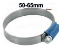
collier de serrage pour durite 50-65mm. Collier rétro avec les bords remontés pour éviter de blesser le caoutchouc. Petite vis de serrage 7mm. Largeur : 12mm. Protection meilleure que les colliers modernes et style rétro bien en accord avec les véhicules de collection anciens.
