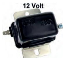
**12 Volt** régulateur de charge courant alternatif 12V, universel, raccords: IGN=cosse 15, FLD= DF de l'alternateur (charbons), masse par le boîtier, esthétique, dimensions : boîtier 64mm x 40mm, hauteur ht 56mm, plaque de fixation 83mm x 83mm, entraxe de 60 à 70mm
