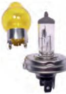
ampoule 6volts, type Code Européen culot P45T (modèle R2), 55/60 Watt, ampoule à iode comme type H4, livré avec bulbe jaune, "2 en 1" : cette ampoule peut être utilisée en blanc ou en jaune!
