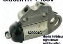
cylindre de roue, Citroën HY, 15cv, avant droite inf., diamètre piston 32 mm, raccord tube 12mmx100, n° d'origine 620004C.
