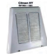
capot moteur, Citroën HY à partir de 1964, refabrication en polyester et métal de l'ancien modèle. Belle qualité avec charnière et verrouillage, n° d'origine HY852-01B
