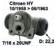
cylindre de roue, Citroën HY de 10.1958 à 06.1963, arrière, n° d'origine HY45305, piston 22,2 mm, raccord 7/16 x 20 UNF, raccord flasque 36 mm, longueur hors tout 68 mm. Made in France
