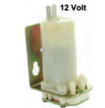
pompe de lave-glace 12 volts. Modèle universel de haute qualité avec support galvanisé, Made in EU. Voir sens de montage haut/bas sur la photo: moteur électrique en haut et partie pompe en bas. Si la pompe est montée dans l'autre sens, elle n'aspire que de l'air.
