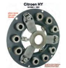
mécanisme d'embrayage, Citroën HY à partir de 10.1968, pièce neuve, n° d'origine HY8312-000B. Mécanisme pré-réglé à la hauteur nominale selon l'opération Citroën H312-2 pour un disque de 9,3mm d'épaisseur. La hauteur de la glace du mécanisme doit impérativement être réglée si l'épaisseur du disque diffère de l'origine. Voir l'opération H312-2 du manuel Citroën. Produit de qualité Made by Franzose/CiPeRe
