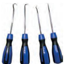
crochets outils (4pcs) longueur 135mm pour sortir les joints toriques, joints de tubes hydraulique, etc. 1x droit et pointu, 1x 90° et pointu, 1x crochet et 1x alene
