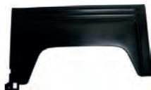
aile arrière, Citroën HY à partir de 1968, aile gauche, découpe rectangulaire, refabrication en tôle
