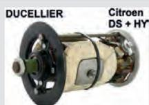
**DUCELLIER** Citroën DS + HY dynamo Ducellier, kit de réparation pour dynamo 12 volt 350 watts de série 7. Pour boîtier de diam. 88,0mm, diam. ext. 103mm, longueur 153 - 154mm. Contient: couvercles avant et arrière, induit, balais. Bobinage Ducellier d'origine (stock ancien)
