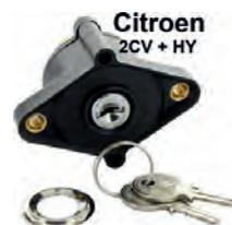
contact à clé, Citroën 2cv, HY, contacteur au tableau de bord pour véhicules équipé d'un bouton de démarrage, livré avec 2 clés. Fixations: 2 filetages M5 au pas de 80 (norme métrique Iso). Citroën utilisait un filetage M5 au pas de 75 jusque dans les années 80. Commandez 2 vis M5 au pas de 80 en complément.
