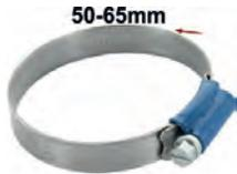
collier de serrage pour durite 50-65mm. Collier rétro avec les bords remontés pour éviter de blesser le caoutchouc. Petite vis de serrage 7mm. Largeur : 12mm. Protection meilleure que les colliers modernes et style rétro bien en accord avec les véhicules de collection anciens.
