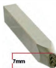
tampon doubles chevrons Citroën, hauteur 7mm pour le marquage des pièces de rechange, de tôlerie ou pour le contrôle qualité
