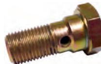
vis creuse de banjo pour maître-cylindre, Citroën Traction 11cv, HY, Peugeot 203. Vis montée sur l'avant du maître-cylindre et fixant la répartition des tubes pas de vis 1/2 x 20 UNF, pour raccord 15mm, longueur sans la tête 29mm
