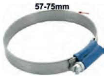
collier de serrage pour durite 57-75mm. Collier rétro avec les bords remontés pour éviter de blesser le caoutchouc. Petite vis de serrage 7mm. Largeur : 12mm. Protection meilleure que les colliers modernes et style rétro bien en accord avec les véhicules de collection anciens.
