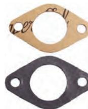
joints sous carburateur oval, ID19, HY, Traction - 11cv, Peugeot, diamètre 34mm, de goujon à goujon milieu env. 61mm, n° d'origine 481717
