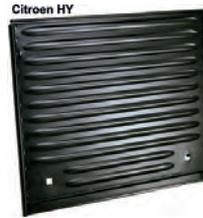
panneau de roue de secours, Citroën HY, en tôle, refabrication identique à la pièce d'origine
