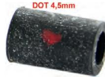
joint de tube hydraulique de frein de 4,5mm pour circuit DOT (rouge), raccords vissés M9, Citroën 2CV, HY
