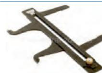
jauge, pied à coulisse d'inspection de tambours de frein, comparateur intérieur de tambour. Outil spécifique pour tambours de frein. Le diamètre intérieur doit être mesuré et la tolérance d'usure contrôlée. Le diamètre mesuré doit être compatible au diamètre des garnitures moins 2mm. Ceci permet d'avoir des freins bien réglés et cela peut éviter un risque de fuite hydraulique au cylindre si la garde est trop grande. Lecture métrique et en pouce pour tambours de 160 à 400mm.
