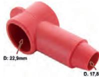
caoutchouc de protection de connection de démarreur pour câble de diamètre 17,8mm max. Diamètre intérieur 22,9mm, couleur rouge
