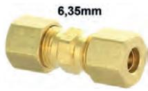
raccord union bicône pour tube hydraulique et tube de frein de 6,35mm, Citroën 2CV, DS, HY etc..., pour une réparation rapide sans collet
