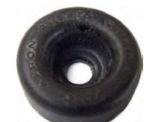
pare-poussière sur piston de cylindre de roue arrière, Citroën HY, piston 7/8" (22,225mm) Made in France
