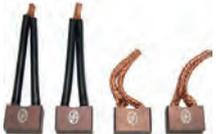
balais de démarrage Ducellier, Citroën DS pour Ducellier 6182A, Traction - 11cv et 15cv, HY, dimensions 19x8.8mm, n° d'origine 701841
