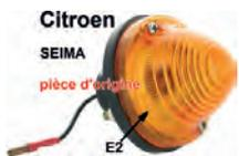
clignotant avant, Citroën 2CV avant (sans son support), AK400, Méhari et DS break arrière, HY, adaptable sur Renault 4L série 1, produit d'origine Seima 3054, 3055, homologué ECE, socle et porte ampoule en métal, diam. du cabochon 68,5mm
