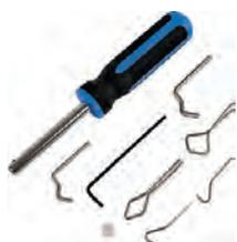
outil de pose de joints à clé, idéal pour véhicules anciens et de collection. Outillage atelier spécial pour la dépose et la pose des joints de vitrage automobile (pare-brise, lunette, vitres latérales). Permet d'écarter la fente du joint pour y poser le jonc (clé)
