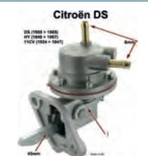
pompe à essence métal, Citroën HY, 1911 cm3 de 1948 à 1967, Citroën DS de 1955 à 1965, 11 cv (Traction Avant) de 1934 à 1957, mécanisme avec levier long (env. 43mm), branchements entrée et sortie 6 mm, avec amorçage à main, produit de qualité, Made in EU.
