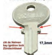
ébauche de clé de Neiman 2CV, modèle équipés d'un neiman avec bouton de démarrage séparé, également pour DS avant 1968, petit modèle pour véhicules avec bouton de démarrage, longueur de tige/panneton 17,3mm et largeur 7,0mm
