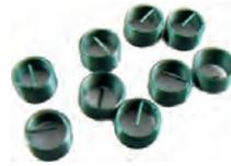
filets rapportés pour réparer un pas de vis abîmée, Helicoil M14 x 1,25 x 16,4 pour bougies par ex., 10pces, se monte avec l'outil 20947
