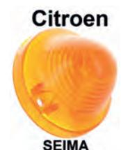
cabochon de clignotant, Citroën 2CV, Ami6, AK et DS break arrière, HY, adaptable sur Renault 4L ancien modèle couleur orange, pour modèle SEIMA, n° d'origine AZ575210A, diam. ext 68mm, entraxe env. 58mm, hauteur de la collerette à l'int.: 10mm. l'unité, sans homologation ECE
