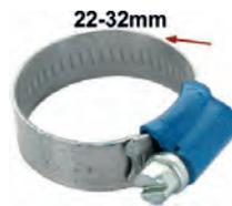
collier de serrage pour durite 22-32mm. Collier rétro avec les bords remontés pour éviter de blesser le caoutchouc. Petite vis de serrage 7mm. Largeur : 12mm. Protection meilleure que les colliers modernes et style rétro bien en accord avec les véhicules de collection anciens.
