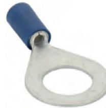
cosse à sertir ronde, diamètre 10mm langue à visser, bleu: pour fil de 2,3 à 5,0mm
