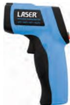
thermomètre infrarouge électronique, permet de mesurer la température de la tubulure d'échappement afin de vérifier si les cylindres fonctionnent bien, ou de voir la répartition de l'eau dans le radiateur par exemple. Matériel professionnel de bonne qualité
