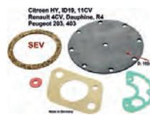
kit de réparation de pompe à essence SEV mécanique, Traction - 11cv et 15cv, HY, Renault Dauphine, Peugeot 203, 403 et autres anciennes, diamètre membrane 102mm. Made in Germany.
