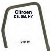
goupille de rotule sous tige de suspension arrière, Citroën DS, SM et HY avec suspension hydraulique, n° d'origine D434-80
