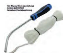
tire-fil pour pose de vitres voitures et pare-brise non collées. Outil très pratique avec un cordon permettant de tirer la lèvres caoutchouc d'un joint sur la feuillure de tôle. Indispensable dans les garages et ateliers spécialisés véhicules anciens et de collection.
