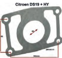
joint de tubulure d'admission, DS19, HY après 1963, n° d'origine DM141-11, diamètre 45mm, entraxe horizontale 103mm, entraxe verticale 62mm, trous de 9,0mm pour les goujons.
