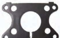
joint de tubulure côté admission, Citroën DS jusque 09.1968 moteurs DY, DL, DLF, Citroën HY, diam. int. 46mm, entraxe horizontale 105mm, entraxe verticale 63mm, trous de 8,0mm pour les goujons, n° d'origine DY141-11
