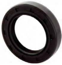
joint spi de différentiel, Citroën HY et Citroën 15-Six, 15cv, dimensions 61 x 40 x 12,5mm, matériau Vitton, n° d'origine ZC96112645U.
