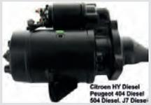
démarrer, Peugeot 404D, 504 1,9D, Citroën HY Diesel, 12 volts, 1,95 KW, 9 dents, fixation 3 points, angle de montage 48° à gauche, tourne dans le sens des aiguilles d'une montre, pièce neuve vendue sans consigne
