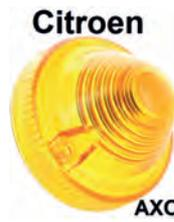
cabochon de clignotant, Citroën 2CV, Ami6, AK et DS break arrière, HY, adaptable sur Renault 4L ancien modèle couleur orange, pour modèle AXO, diamètre ext. 71 mm, entraxe env. 55mm, hauteur de la collerette à l'int.: 14,5mm, l'unité, refabrication sans homologation technique ECE
