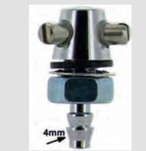
gicleur de lave-glace universel chromée, raccord de durite diam. 4mm, fixation avec un écrou sous le capot, 2 jets réglables, pour trou d'emboîtement 8,0mm.
