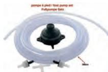
pompe à pied pour lave-glace. Kit complet comprenant 2 clapets anti-retour, un raccord trois-voies et 3 mètres de durite. Montage: raccordez le raccord 3 voies à une durite vers la pompe + une durite qui vient du bocal + une durite qui va vers le gicleur. Poser un clapet anti-retour sur la durite d'aspiration du bocal et un clapet anti-retour sur la durite qui va vers le gicleur. Les clapets ont une flèche qui indique le sens de circulation du liquide.
