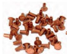
rivet de garnitures sur machoières de frein, vendu à l'unité. Pour Traction, HY, Peugeot 203, 403, Renault Frégate etc., prévoir 92 pcs pour Traction. diamètre 4mm, longueur 8mm
