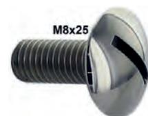
vis Inox de grille de calandre, Traction - 11cv et 15cv, 8mmx25, diamètre de tête 20mm, n° d'origine 331101, également pour pare-chocs Peugeot et autres
