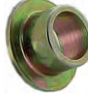
ligne d'échappement - fixations, Citroën DS et 11cv, protection métallique autour de la vis traversant la bande caoutchouc de fixation
