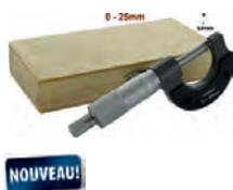
palmer - micromètre d'extérieur, plage de mesure 0-25mm, précision 0,01mm. Indispensable pour vérifier les cotes des axes de pivot, plaquettes de réglage de soupape, etc...
