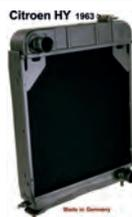
radiateur, Citroën HY à partir de 1963, éch.std., consigne 250 euros, Made in Germany. Radiateur d'origine démonté, microbillé, peint et remonté avec une grille neuve.
