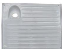
tôle nervurée / tôle ondulée latérale en polyester sur le réservoir, Citroën HY, refabrication de très belle qualité(même les point de soudures d'origine ont été reproduits)
