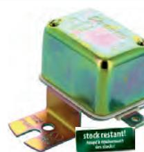
régulateur de charge électromécanique 12 volts, 2CV, DS HY, 2 fils, raccords vissés, voir note 14231E (IGN=+ pour Voltmètre; CPO=EXC pour l'alternateur, masse par le boîtier)
