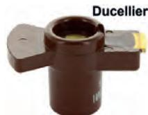
rotor Ducellier, Citroën DS (de 04.1966 à 10.1972), HY, BX, C15, CX, Visa, XM, GS, Peugeot 504, 205, 505, 104, Renault R11, R18, R19, R21, R12. Diam. int. 10mm Innendurchmesser, longueur du doigt = 48 mm. hauteur HT = 31 mm, profondeur int = 13 mm. Made in France.
