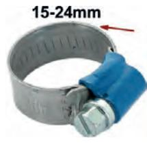
collier de serrage pour durite 15-24mm. Collier rétro avec les bords remontés pour éviter de blesser le caoutchouc. Petite vis de serrage 7mm. Largeur : 12mm. Protection meilleure que les colliers modernes et style rétro bien en accord avec les véhicules de collection anciens.
