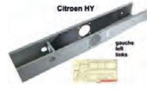
profilé sous caisse, Citroën HY, arrière gauche, au niveau de l'essieu arrière, tôle avec tout ses renforts, longueur 120cm
