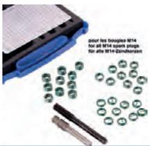
kit de réparation Helicoil - pour réparer un pas de vis abîmé, pour les bougies M14. Outils : taraud + outil de pose. filets: 10x Helicoil M14x1,25x17,5 et 10x Helicoil M14x1,25x12,7 (pour bougies 2CV, R4, etc...)
