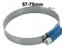
collier de serrage pour durite 57-75mm. Collier rétro avec les bords remontés pour éviter de blesser le caoutchouc. Petite vis de serrage 7mm. Largeur : 12mm. Protection meilleure que les colliers modernes et style rétro bien en accord avec les véhicules de collection anciens.
