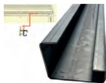
rail de porte coulissante (horizontal), Citroën HY, 2 pièces. Pièce adaptable différente de la pièce d'origine. Il n'est pas nécessaire de soulever le toit pour la souder. Longueur 1250mm
