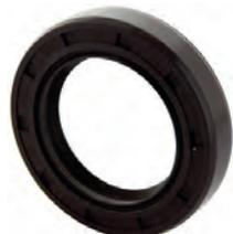
joint spi de différentiel, Citroën HY et Citroën 15-Six, 15cv, dimensions 61 x 40 x 12,5mm, matériau Vitton, n° d'origine ZC96112645U.
