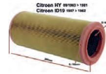
cartouche de filtre à air, HY après 09.1963, ID DS de 1957 à 1962, en remplacement de l'origine, longueur 268mm, diamètre ext. 108mm, int. 69mm
