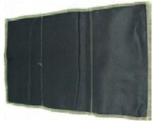
couverture antifeu pour travaux de soudure, protège jusque 1100°C, limite les risques d'incendie, flexible, prend bien la forme à protéger, longue durée, sans amiante, 330x500mm
