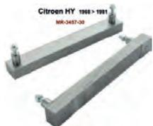
jauge de réglage de hauteur des linguets du mécanisme d'embrayage MR-3457-30, pour Citroën HY à partir de 1968. La hauteur de la glace du mécanisme doit impérativement être réglée selon l'épaisseur du disque et l'usure du volant moteur. Voir l'opération H312-3 du manuel Citroën. A chaque remontage, le contrôle est indispensable. Le bon fonctionnement n'est pas garanti sans ce réglage. Lisez bien le manuel avant de faire le montage ! Produit de qualité Made by Franzose/CiPeRe
