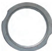
joint de tube d'échappement, HY diesel Indenor XDP88, Peugeot J7 moteurs XDP88, XDP4.88, XDP90, XDPX90, Peugeot 504 2.3D (XD2), diamètre int. 46mm, ext. 60mm, avec 2 rainures, n° d'origine 171019
