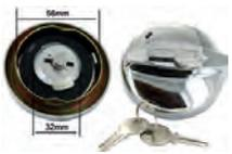
bouchon de réservoir à clé, chromé, 2CV, DS, traction, HY, AK, très belle refabrication, huiler le mécanisme de serrure avant le montage. Attention: pour fermer et ouvrir le bouchon, le tourner de seulement 1/4 de tour pas plus sinon risque de dégradation
