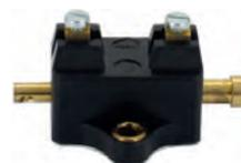
contacteur de feu de stop universel. Le contacteur laisse passer le courant en phase sans appui et coupe le courant lorsque la tige est soit tirée, soit enfoncée. Adaptable pour Citroën Traction 11CV, HY, ou autres. Livré avec le couvercle caoutchouc.
