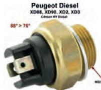
interrupteur thermostatique - sonde d'eau, Peugeot 504, 505, 604 diesel, moteurs XD88, XD90, XD2 XD3, 88-75°C, pas de vis M22x150
