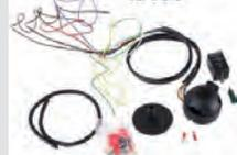
faisceau électrique d'attelage standard , 7 pôles avec branchement de témoin, 12Volt raccord 49 = plus d'alimentation (correspond anciennement au signe +), raccord 49a = sortie relais clignotant avant+arrière (correspond anciennement au signe C), raccord C2 = raccord témoin. raccord 31 = masse (raccorder à la carrosserie si anciennement non-présent), raccorder le témoin d'origine en parallèle sur la fiche 49a
