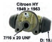
cylindre de roue arrière, Citroën HY 1200kg de 1948 à 1958 et HZ 850kg de 1949 à 1963, diam. de piston 19mm. Made in France
