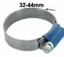
collier de serrage pour durite 32-44mm. Collier rétro avec les bords remontés pour éviter de blesser le caoutchouc. Petite vis de serrage 7mm. Largeur : 12mm. Protection meilleure que les colliers modernes et style rétro bien en accord avec les véhicules de collection anciens.
