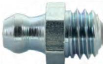
graisseur M8 x 125, graisseur 6 pans H1, droit, clé de 9,0mm
