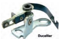
rupteur Ducellier, DS jusque 1962, HY, 11CV, et quelques Renault ou Peugeot de la même époque. Made in France.
