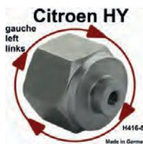
écrou de cardan gauche, Citroën HY, filetage pas à droite, n° d'origine H4168D, couple de serrage 20kgf.m - 200N.m / Made in Germany. Nous avons modifié la dimension pour un serrage avec une douille normale de 36, au lieu du 38 long d'origine.
