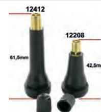
valve de jante Citroën DS, CX, HY, GS, Renault 4L, R5, R6, R8, R10, Peugeot 203, 403, 404, 504, 604, 204, 304, J7, pour trou de 11,3mm, longueur 61,5mm. Modèle long pour montage sur jante avec un enjoliveur de roue
