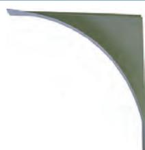
triangle avant gauche, Citroën HY, tôle sous la porte, entre aile et montant vertical de caisse
