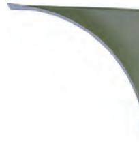
triangle avant gauche, Citroën HY, tôle sous la porte, entre aile et montant vertical de caisse
