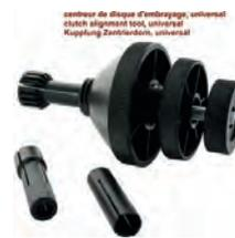
centreur de disque d'embrayage universel, outil réglable pour volant moteur avec ou sans roulement. Diamètre de vis tige de 14 à 28mm et cône pour mécanismes de 35 à 67mm
