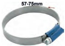
collier de serrage pour durite 57-75mm. Collier rétro avec les bords remontés pour éviter de blesser le caoutchouc. Petite vis de serrage 7mm. Largeur : 12mm. Protection meilleure que les colliers modernes et style rétro bien en accord avec les véhicules de collection anciens.
