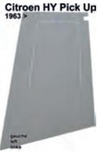
façade arrière gauche, Citroën HY Pick-up à partir de 1963, tôle sans ouverture pour les feux arrière
