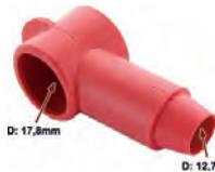
caoutchouc de protection de connection de démarreur pour câble de diamètre 12,7mm max. Diamètre intérieur 17,8mm, couleur rouge
