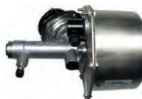
assistance de freinage type Hydrovac, produit universel pour tous véhicules anciens. Petit modèle 5 1/2 pouces (13,97cm), pour simple circuit, permet d'équiper un véhicule de l'assistance au freinage ou en remplacement d'un hydrovac défectueux. La dépression peut être fournie par une pompe électrique. Made in Spain.
