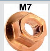
écrou cuivré M7 pour tubulure d'échappement par exemple. Il est important d'utiliser des écrous cuivrés sur la tubulure d'échappement et sur l'échappement en général pour qu'ils ne collent pas à chaud et afin d'éviter la rouille
