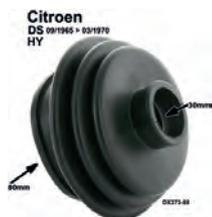
soufflet de cardan côté boîte de vitesse, Citroën DS de 09.1965 à 03.1970, pour tripode à boîtier alu rond, diamètres 80 et 30,0mm
