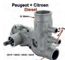
pompe à eau, Citroën HY Diesel, Peugeot 505, J7 et J9 Diesel, les 2 petits raccords doivent être fermés par un bouchon si nécessaire, n° d'origine 120187, 120295, 120291, 120288, 120299, diamètres de raccords de durites: 3x 17mm, 1x 55mm, 1x 42mm.
