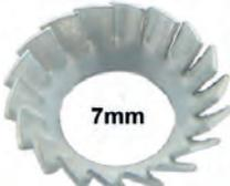
rondelle éventail, Citroën Traction - 11cv et autres anciennes, diamètre int. 7mm, ext. 14mm, fixation de tambour de frein, rondelle en cuvette à denture ext.
