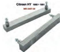
jauge de réglage de hauteur des linguets du mécanisme d'embrayage MR-3457-30, pour Citroën HY à partir de 1968. La hauteur de la glace du mécanisme doit impérativement être réglée selon l'épaisseur du disque et l'usure du volant moteur. Voir l'opération H312-3 du manuel Citroën. A chaque remontage, le contrôle est indispensable. Le bon fonctionnement n'est pas garanti sans ce réglage. Lisez bien le manuel avant de faire le montage ! Produit de qualité Made by Franzone/CiPeRe
