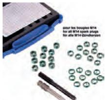
kit de réparation Helicoil - pour réparer un pas de vis abîmé, pour les bougies M14. Outils : taraud + outil de pose. filets: 10x Helicoil M14x1,25x17,5 et 10x Helicoil M14x1,25x12,7 (pour bougies 2CV, R4, etc...)
