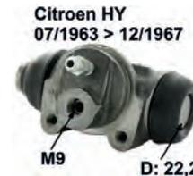
cylindre de roue, Citroën HY de 06.1963 à 12.1967, arrière, n° d'origine HY45305A, diamètre piston 22,2 mm, raccord tube 9 mm, raccord flasque 36 mm, longueur hors tout 68 mm, équipé Bendix-Bosch. Made in France
