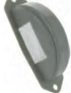
cabochon d'éclairage de plaque, Citroën 2CV jusque 1954, AZU 250, HY premiers modèles et éclairage de plaque de police au milieu sur la haute de la façade arrière
