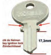
ébauche de clé de Neiman 2CV, modèle équipés d'un neiman avec bouton de démarrage séparé, également pour DS avant 1968, petit modèle pour véhicules avec bouton de démarrage, longueur de tige/panneton 17,3mm et largeur 7,0mm
