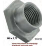
mécanisme d'embrayage à 3 leviers : écrou de réglage des linguets, pas de vis M8 x 75, clé de 14mm, n° d'origine ZC9491056U
