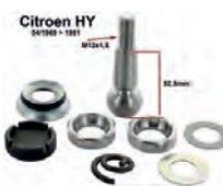
rotule de direction, Citroën HY à partir de 04.1969, kit de réparation de tête de biellette de direction côté ext., longueur: 74mm, filetage: M12 x 150, n° d'origine HY443-100 + ZC9601876U.
