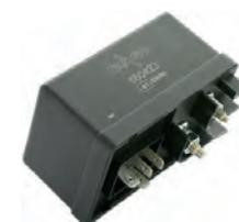
relais de préchauffage, Citroën HY Diesel, Citroën CX 2,5 Diesel, Peugeot 504 D (1,9 - 2,3), Peugeot 404D, Peugeot 304 D, Peugeot 305D, Renault R20 D.
