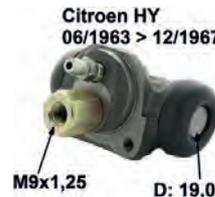
cylindre de roue, Citroën HY de 06.1963 à 12.1967, arrière, n° d'origine HY45305D, diamètre piston 19 mm, raccord tube 9x1,25 mm, raccord flasque 36 mm, longueur hors tout 68 mm. Made in France
