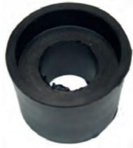
bague caoutchouc de colonne de direction (en haut), Citroën HY, Traction - 11cv et 15cv, diam. sup. 45,34mm, diam. inf. 42,34mm, n° d'origine 602169
