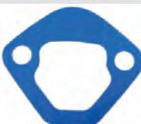
joint d'embase de pompe à essence en matériau spécial de marque Klingersil. Ce joint de 0,5 mm d'épaisseur remplaçant le papier offre une haute résistance aux huiles et carburants.
