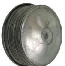
réservoir de liquide de frein (couvercle), Citroën Traction - 11cv, 2CV ancien modèle, HY, Panhard, Peugeot 203, 403, 404, bouchon pour bocal de Lockheed en verre, diamètre filetage 44mm
