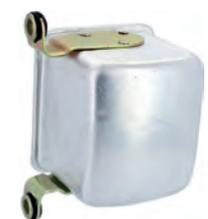
régulateur de charge courant continu, pour dynamo 12V, universel, raccords D= sur cosse 15 à D ou D+ de la dynamo, E= masse, A=batterie plus, F= excitation dynamo, réglable, montage suspendu. N'est pas compatible avec un alternateur!
